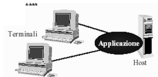
E' l'architettura hardware ad essere centralizzata, tutti i terminali non hanno la cpu.
